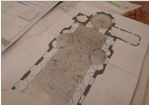
Plan mit dem Rissbild und Dokumentation der ausgeführten Massnahmen.
