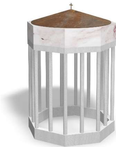
Entwurf des Taufbeckens – die Ausführung erfolgt nun mit einer engeren Platzierung der Holzstäbe.
