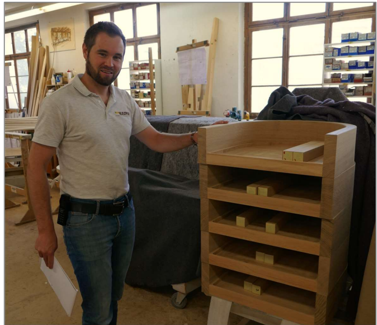
Sandro Weber der Schreinerei Kasper AG zeigt die fertigen Rundbogenteile am Beispiel der Sedilien.
